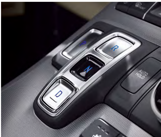
Переключение режимов 8-ступенчатой автоматической коробки передач кнопками
