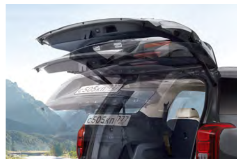
Багажник с функцией автоматического открывания-закрывания и регулировкой скорости
