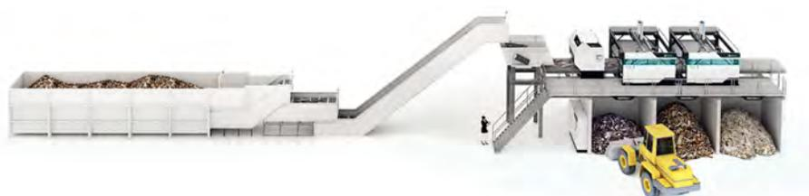
ZenRobotics используется в основном для разбора строительного мусора, который в большинстве стран просто свозят на свалку, где он лежит годами. В Финляндии же часть этого мусора получает новую жизнь.
