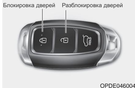
Для блокирования дверей используется кнопка на наружной ручке двери (при этом необходимо иметь при себе электронный ключ) или кнопка блокирования дверей на электронном ключе.
