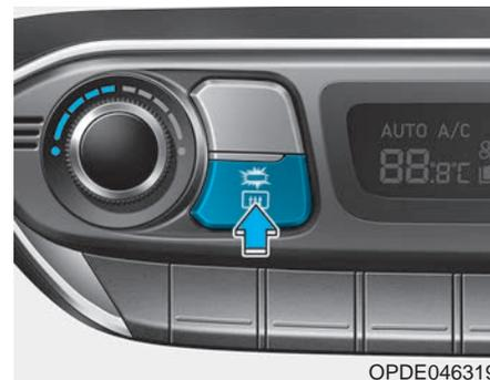
При работающем двигателе обогреватель нагревает заднее окно изнутри и снаружи для устранения инея, запотевания и ледяного налета.
