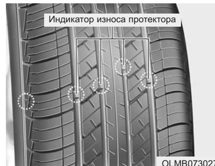
Если шина изношена равномерно, то индикатор износа появится в виде сплошной полосы, расположенной поперек протектора. Это означает, что на шине остался слой протектора толщиной менее 1,6 мм (1/16 дюйма). Если это произошло, замените шину.
