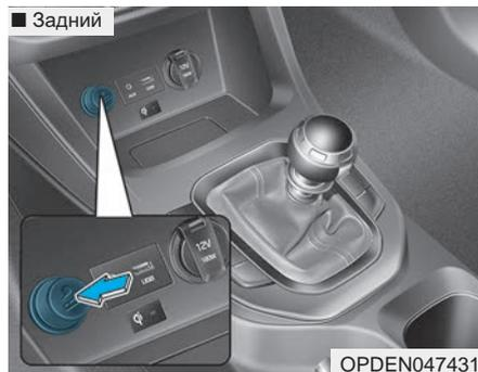
Для использования прикуривателя выключатель зажигания должен быть установлен в положение ACC или ON.
