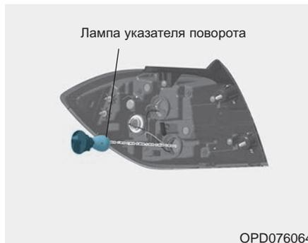
6. Отделите гнездо от деталей узла, вращая его против часовой стрелки, пока выступы на корпусе гнезда не совместятся с пазами в деталях узла.
