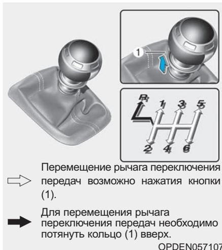
Перемещение рычага переключения передач возможно нажатия кнопки (1).
