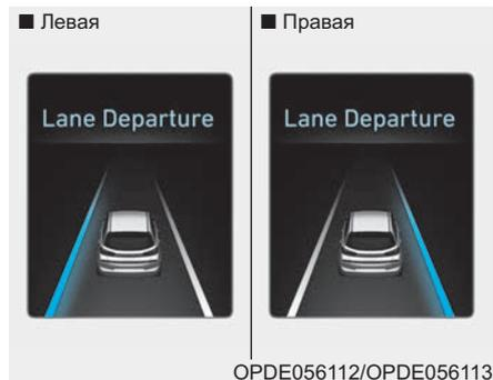
На ЖК-дисплее появляется визуальное предупреждение. В зависимости от направления отклонения транспортного средства на ЖК-дисплее будет мигать левая или правая линия границы полосы движения.
