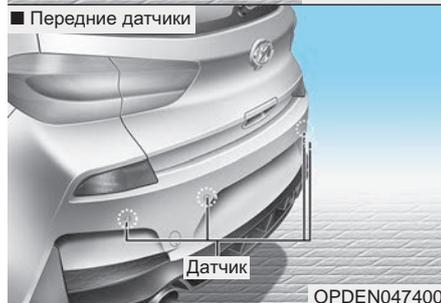
Системой помощи при парковке подаются звуковые сигналы при обнаружении какого-либо объекта на расстоянии 100 см (39 дюймов) спереди и 120 см (47 дюймов) сзади транспортного средства.
