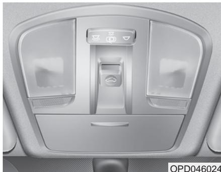
Для открытия или закрытия верхнего люка переключатель зажигания должен находиться в положении ON (ВКЛ).
