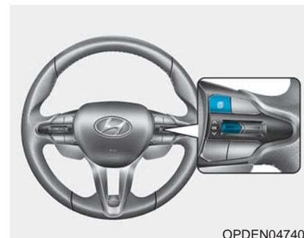
Для изменения режима бортового компьютера следует вращать переключатель «^, v» на рулевом колесе.
