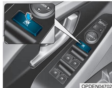
Водитель может заблокировать переключатели стеклоподъемников задних дверей с помощью переключателя блокировки стеклоподъемников.
