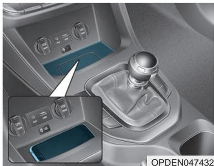
Устройство зарядки для беспроводного мобильного телефона находится на передней консоли.
