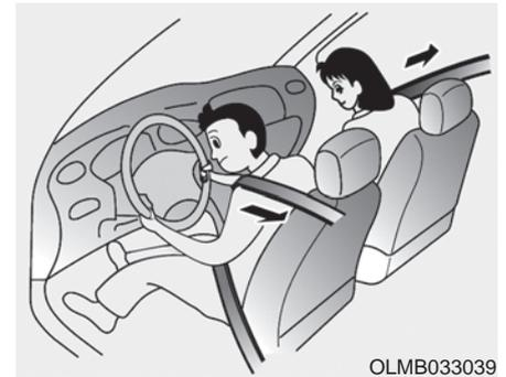
Транспортное средство оборудовано устройствами предварительного натяжения ремней безопасности сидений водителя, переднего пассажира и заднего пассажира (если предусмотрено комплектацией).
