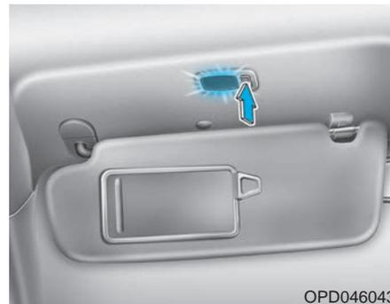
Нажмите этот выключатель для включения или выключения лампы.
