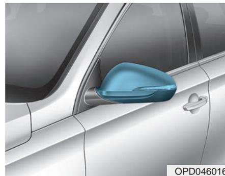
Перед началом движения отрегулируйте угол наклона зеркала.
