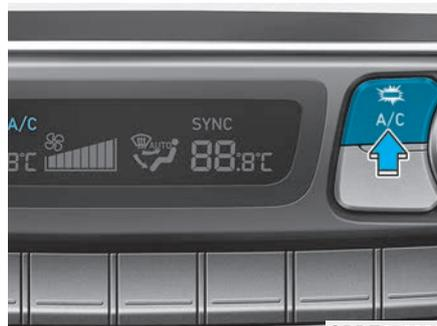
Для включения системы кондиционирования нажмите на кнопку A/C (при этом загорится расположенная в ней контрольная лампа).
