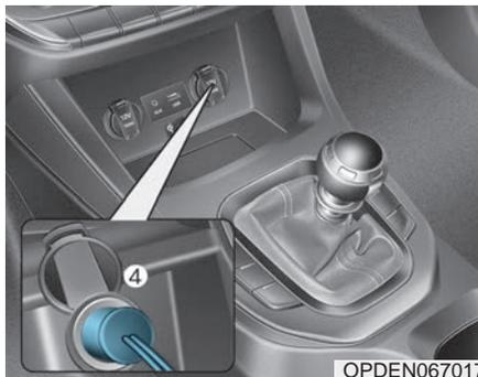
5. Соедините компрессор с розеткой питания автомобиля с помощью кабеля (4) и коннекторов.
