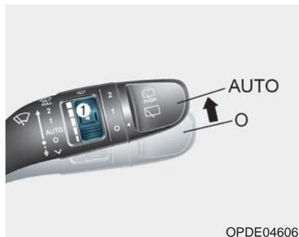
Датчик дождя, расположенный в верхней части ветрового стекла, определяет количество осадков и управляет частотой работы стеклоочистителей. Чем сильнее дождь, тем быстрее они работают.
