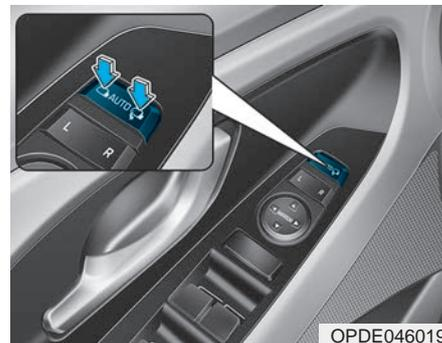
**С электрическим приводом**
