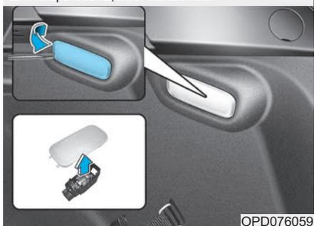
1. С помощью отвертки с плоским шлицом аккуратно подденьте рассеиватель изнутри корпуса лампы.
