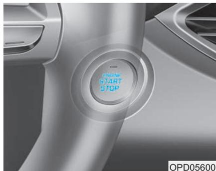
При открытии передней двери загорается кнопка запуска и остановки двигателя. После закрытия двери она горит еще 30 секунд.
