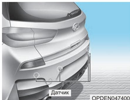
Система помощи при парковке задним ходом подает звуковой сигнал при обнаружении какого-либо объекта на расстоянии до 120 см (50 дюймов) позади автомобиля.
