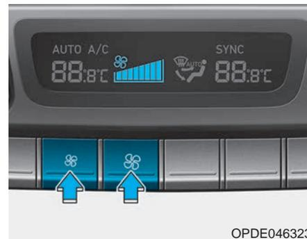
Частоту вращения вентилятора можно менять нажатием на переключатель управления вентилятора.
