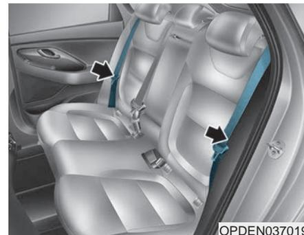
3. Перед складыванием спинки сиденья ремень безопасности должен быть убран в сторону, чтобы он не мешал наклону спинки.
