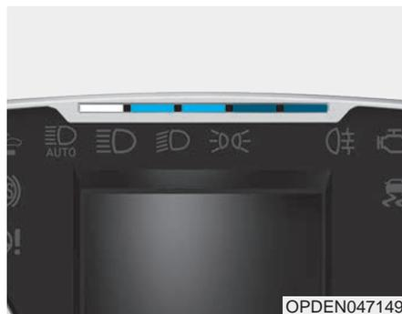
Числом горящих светодиодов указывается соответствующая частота вращения двигателя. При достижении максимально допустимой частоты вращения двигателя загорятся светодиоды различных цветов. Когда начнут мигать все 5 светодиодов, это указывает на наиболее благоприятный момент для переключения на более высокую передачу. Не следует больше откладывать переключение.
