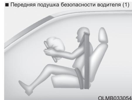
Когда блок управления подушками безопасности обнаруживает достаточно серьезный удар в переднюю часть транспортного средства, он автоматически надувает передние подушки безопасности.
