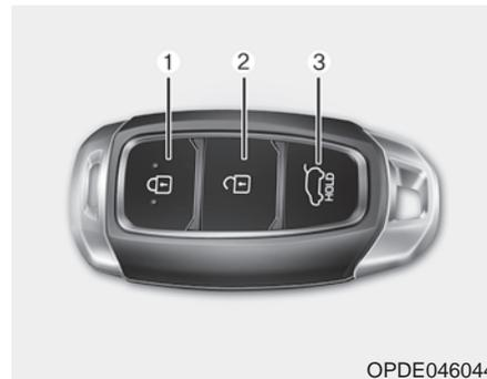
Для автомобилей HYUNDAI используется электронный ключ, которым производится блокирование и разблокирование дверей (и багажник), а также для пуск двигателя.
