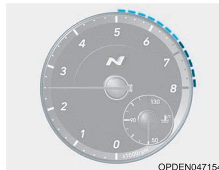
Желтыми и красными светодиодами отображается диапазон рекомендуемых частот вращения двигателя. По мере повышения температуры масла двигателя диапазон рекомендуемых частот вращения двигателя расширяется.
