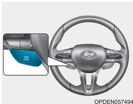
Режим движения можно выбрать в соответствии с предпочтениями водителя или состоянием дороги. После остановки и повторного запуска двигателя система возвращается в режим NORMAL.
