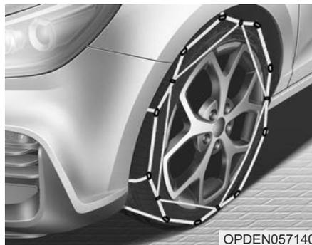
Поскольку боковины радиальных шин тоньше, чем у других типов шин, они могут быть повреждены при установке на них некоторых типов цепей противоскольжения. Поэтому вместо цепей противоскольжения рекомендуется использовать зимние шины. Не устанавливайте цепи противоскольжения на автомобили с алюминиевыми дисками, они не приспособлены для этого.
