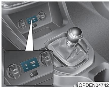
Для подключения аудиоустройств может использоваться порт USB или iPod®.
