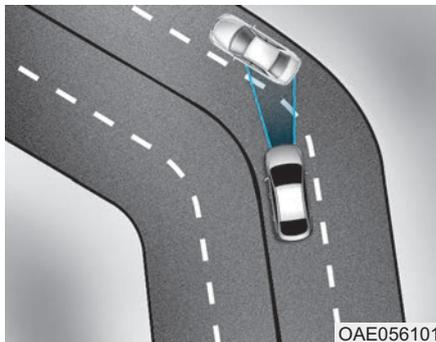
Система АЕВ может распознать автомобиль в следующей полосе при движении по извилистой дороге.
