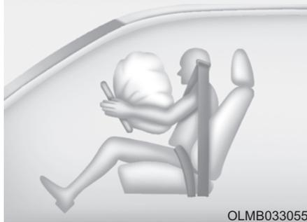
После срабатывания происходит разрыв швов мягкой крышки, которая отделяется под давлением при расширении подушек безопасности. Последующее открытие крышек позволяет полное раскрытие подушек безопасности.
