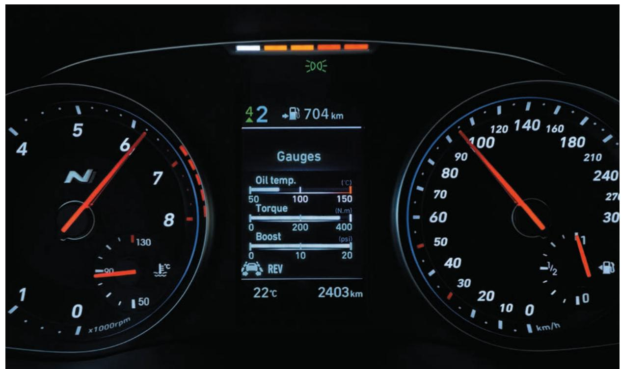
Приборная панель N спроектирована под потребности истинных гонщиков. Мониторинг температуры масла двигателя, крутящего момента, режима работы турбины – всё это одним взглядом. Контроль скорости переключения передач и адаптивных пределов «красных зон» происходит в зависимости от температуры двигателя.
