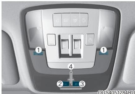
Элементы системы ЭРА ГЛОНАСС, установленные в салоне автомобиля:
