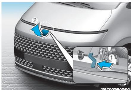
3. Подойдите к автомобилю спереди, приподнимите капот, поднимите вторичную защелку (1) по центру под капотом и поднимите капот (2).
