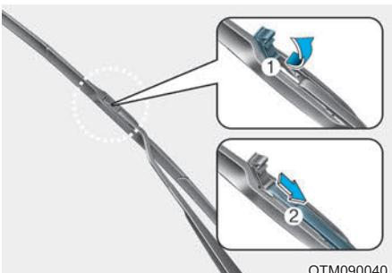
4. Поднимите зажим щетки стеклоочистителя. Затем потяните вниз и снимите узел щетки.
