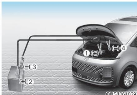
5. Подключите соединительные кабели точно в той последовательности, которая показана на рисунке. Сначала подключите один пусковой кабель к красному (положительному (+)) выводу для пуска от внешнего источника на вашем автомобиле (1).
