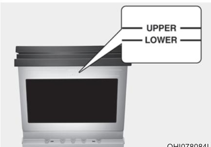
Если автомобиль оснащен аккумулятором с отметками «LOWER», MIN (Нижний уровень (Мин.)) и «UPPER», MAX (Верхний уровень (Макс.)) на боковой стенке, в нем необходимо проверять уровень электролита.
