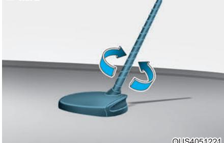
Микромачтовая антенна передает и принимает беспроводные сигналы, например AM/FM, SXM, DAB, GNSS, LTE и т. д.
