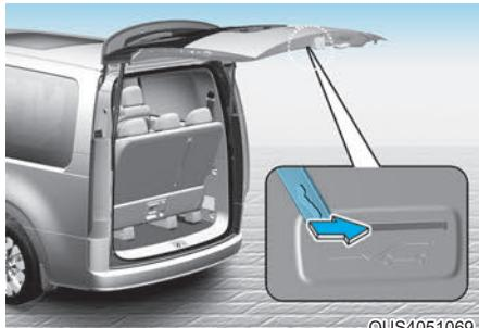
Автомобиль оснащен устройством аварийного открытия крышки багажника, которое находится в ее нижней части внутри автомобиля.
