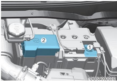
Аккумулятор расположен внизу внутри багажника. При замене аккумулятора сначала отсоедините кабель аккумулятора (1), а затем снимите блок предохранителей аккумулятора (2) со стороны «+».
