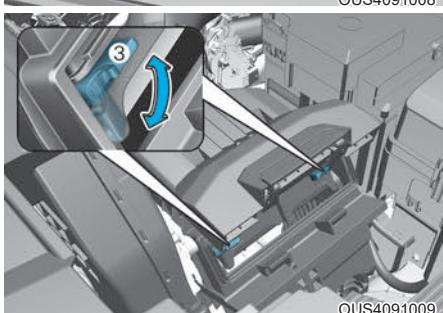
1. Поднимите вверх рычаг (1) на крышке воздушного фильтра и освободите замок.
