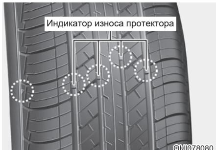
При равномерном износе шины поперек протектора становится виден индикатор износа в виде сплошной полосы. Это значит, что оставшаяся толщина протектора нашине составляет менее 1,6 мм (1/16 дюйма). В этом случае замените шину.
