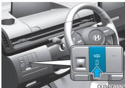
Нажмите кнопку «ISG OFF» (Выкл. ISG), чтобы выключить систему ISG. Загорится индикатор кнопки «ISG OFF» (Выкл. ISG). Для включения системы нажмите кнопку «ISG OFF» (Выкл. ISG) еще раз.
