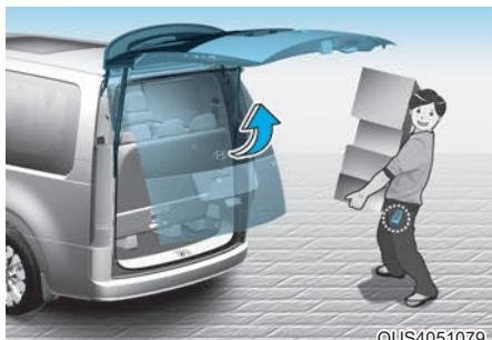
На автомобилях, оснащенных смарт-ключами, багажник можно открыть без прикосновений с помощью автоматического открывания багажника.
