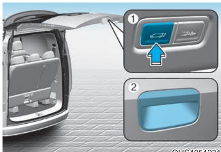
В случае разряда или отсоединения аккумуляторной батареи, а также замены или снятия предохранителя электроприводной крышки багажника необходимо сбросить ее настройки, выполнив перечисленные ниже действия.
