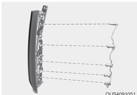
6. Извлеките лампу из патрона, вдавив ее и повернув против часовой стрелки до положения, в котором ее выступы совместятся с прорезями в патроне. Выньте лампу из патрона.
