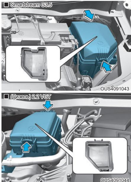
С внутренней стороны крышки блока реле и предохранителей находится этикетка с указанием названий предохранителей/реле и их номинальных характеристик.
