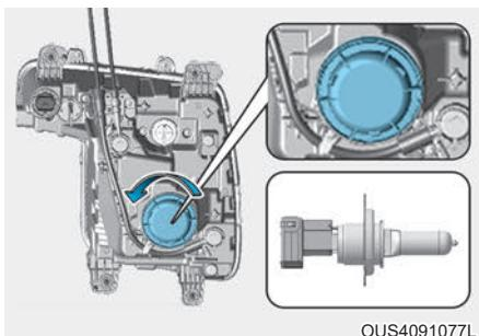
4. Надавите на кожух колеса, отведите его в сторону и извлеките патрон лампы, повернув его против часовой стрелки.
