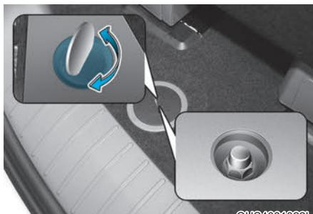
Порядок снятия запасного колеса (тип А):
