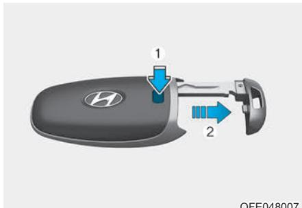
Нажмите кнопку разблокировки (1) и, удерживая ее, извлеките механический ключ (2). Вставьте механический ключ в отверстие для ключа на двери.
